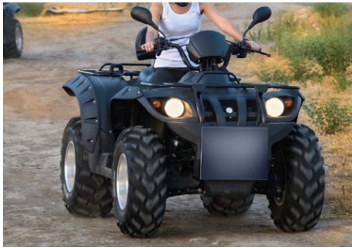
Ein Quad gibt es in unterschiedlichen Größen und Motorisierungen; manche Quads werden auch als ATV bezeichnet, das „All Terrain Vehicle“ bedeutet. Diese Fahrzeuge verfügen meist über einen Allradantrieb und sind deshalb besonders geländegängig. Foto: pixabay
